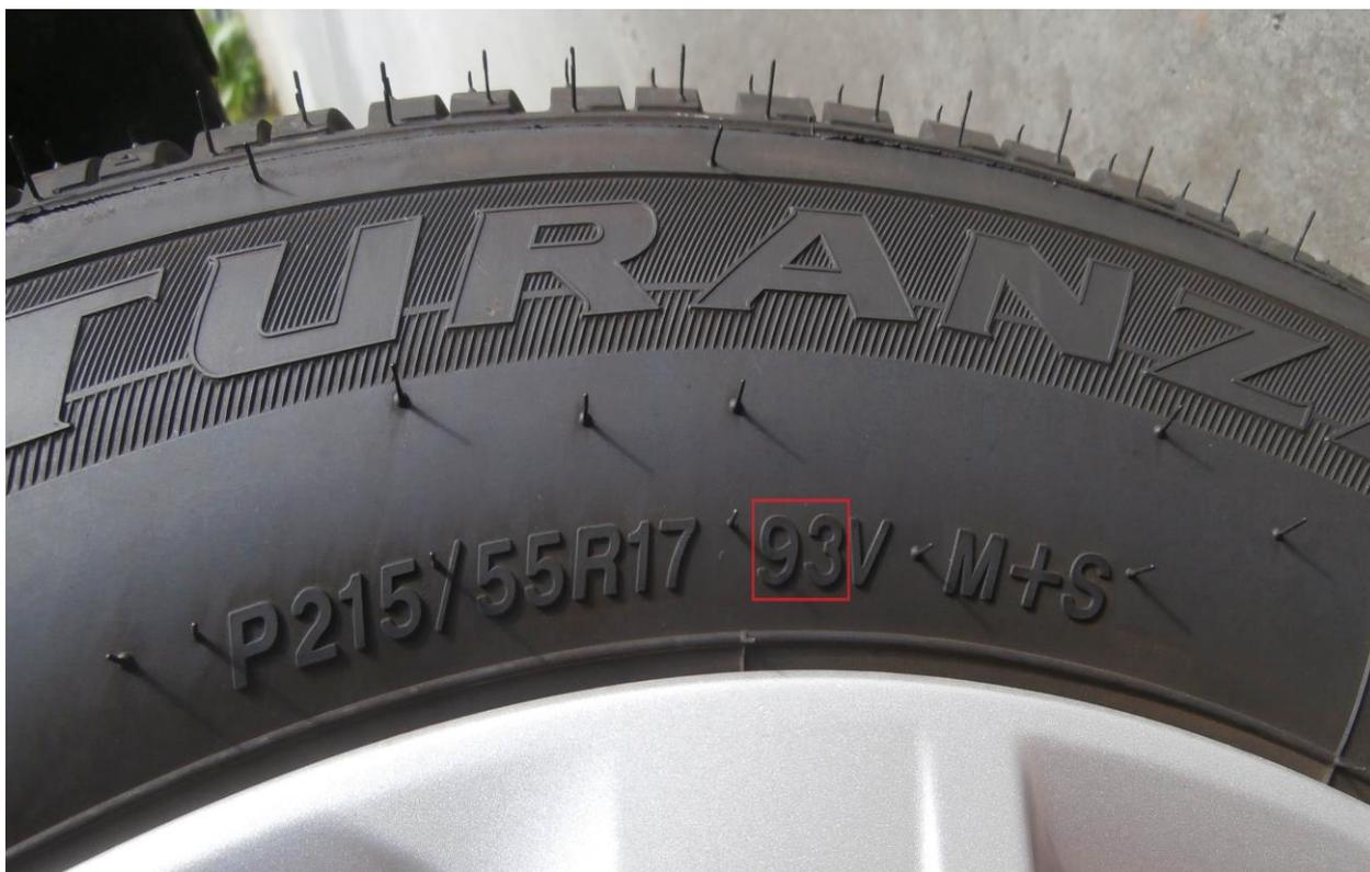
11.3.9.1. Para facilitar o entendimento inerente ao cauculo do peso máximo suportável pelo pneu, anexamos a tabela de índice de carga que explica cada numeração existentes nos pneus.
